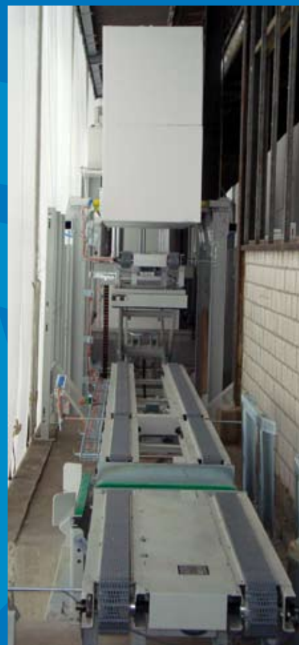
Elle tourne maintenant – la nouvelle installation d'élastification tout automatique pour SAGEX et Neopor®.
